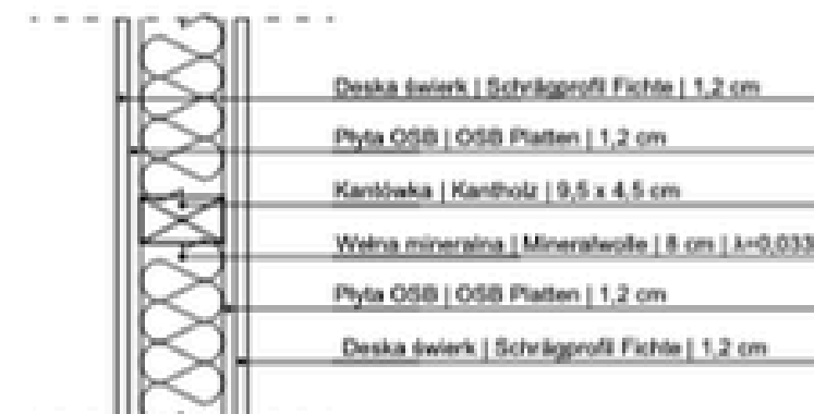
W03 | Ściana wewnętrzna | Innenwand | 14,5 cm
