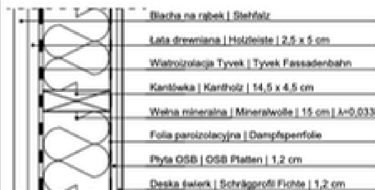
W01 | Ściana zewnętrzna | Außenwand | 23,5 cm
